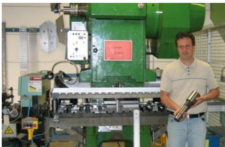
Dick Fröberg med en pelare och bussning av typ Million Guide diam. 60. Pressens hastighet 165 slag/min. Avklippet ligger 700 mm från centrum, en bidragande orsak till snedbelastningen. För mer info kontakta: Lideco AB tel. 0321-53 03 50
